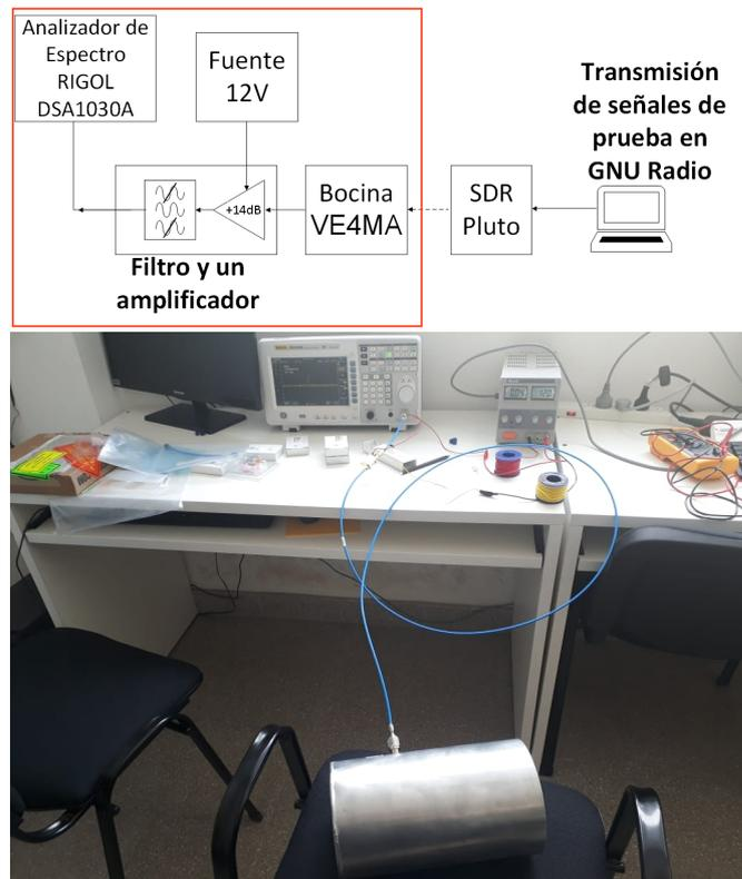
Figura 3: Esquema empleado para la validación de los componentes (panel superior). Analizador de espectro, fuente de 12 volt, filtro amplificador y bocina, en el armado de la cadena de recepción (sección recuadrada, panel superior) para las pruebas de validación (panel inferior).
