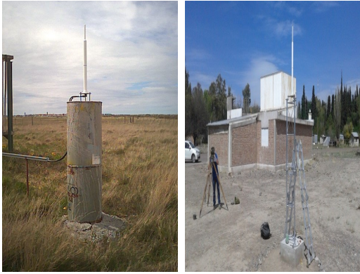
Figura 5: Antenas DORIS de la Estación EARG y OAFA
